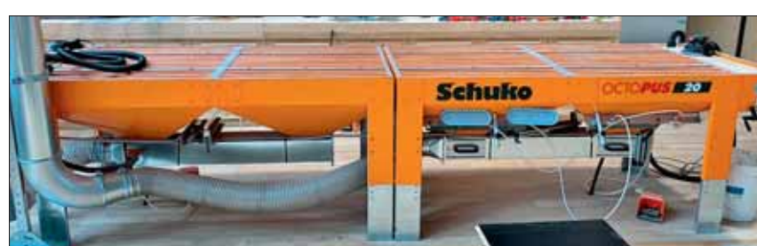
Schleiftisch „Octopus 20“ von Schuko mit Anschlüssen der Absaugung
